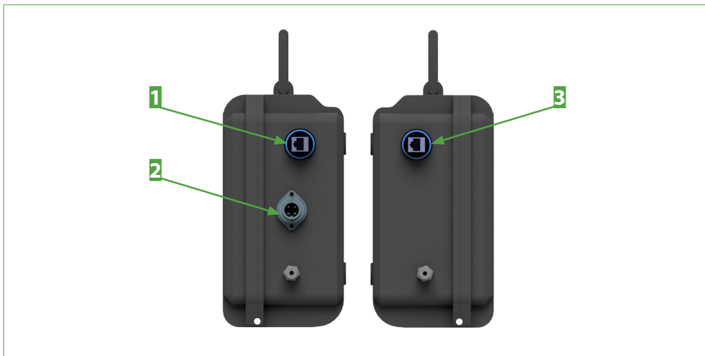
Abb. 44: Elektrische Anschlüsse an den Seiten des Audit-MFCs
