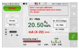
Fig. 84: Manual calibration error
